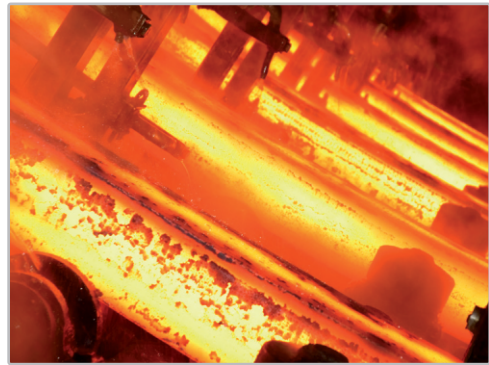
连续铸造生产线的出料工段
